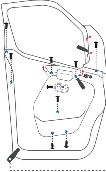
Com uma espátula fina, retire a tampa dos parafusos. Em seguida retire os parafusos para retirar o forro da porta e iniciar a instalação.
